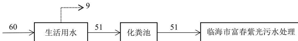
图 2-2 项目水平衡图 (单位 t/a)
