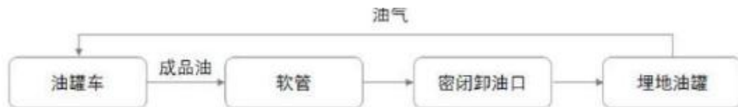
图 2-3 项目卸油工艺流程图
