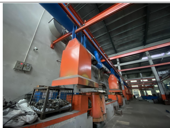
熔化废气收集、耐高温袋式除尘器
