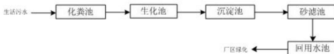
图 3-1 环评生活污水处理工艺流程图
