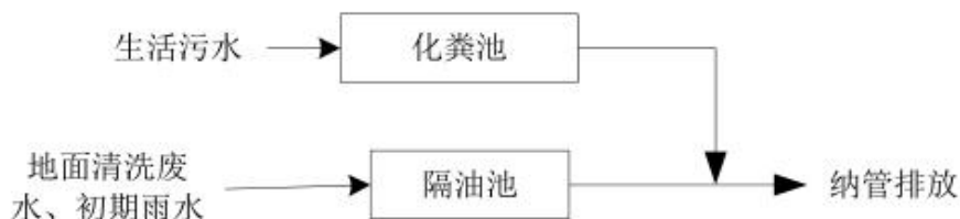
图 3-1 废水处理设施流程图
