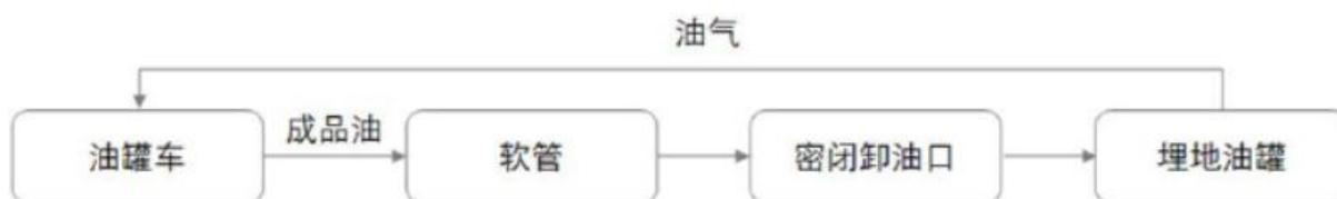
图 2-2 卸油工艺流程图
