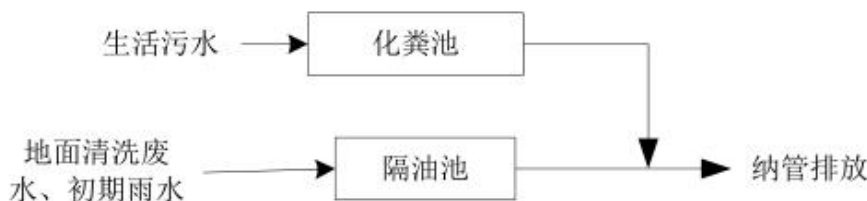
图 3-1 废水处理流程图
