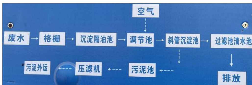
图 3-1 企业废水处理流程图
