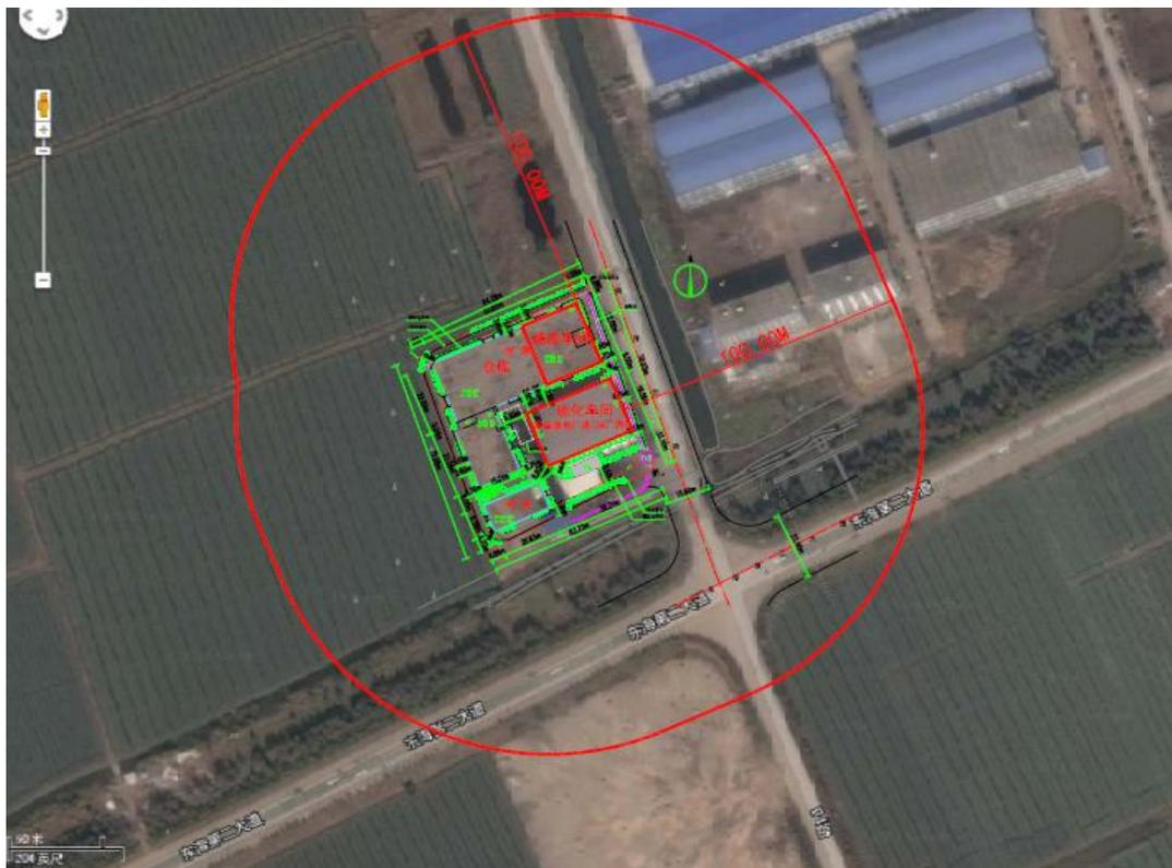
图9-1 卫生防护距离包络线示意图
