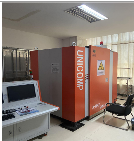
图 4-1 探伤室（整体铅房）现状
