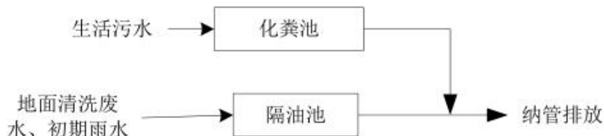
图 3-1 废水处理设施流程图
