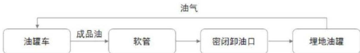
图 2-1 卸油工艺流程图
